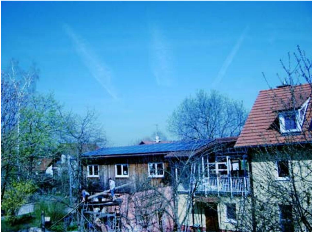
Photovoltaik-Paneele zur Stromerzeugung, 5 Uwp
